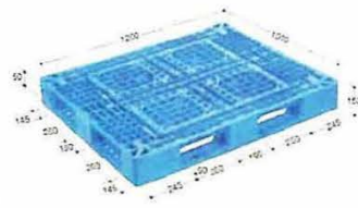
■ LA-1210 外寸：1200×1000×150mm 仕様：片面・四方差し 質量：12.3kg 動荷重：1000kg
