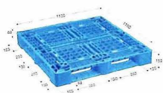
■ SLA-1111 外寸：1100×1100×150mm 仕様：片面・四方差し 質量：10.4kg 動荷重：1000kg
