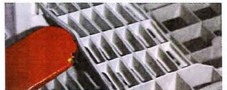
格子リブ一体構造のため破損無し
