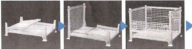
●折りたたみ時 ●側面を起こします ●前後扉面を起こして、開閉金具をそれぞれ差し込みます。
