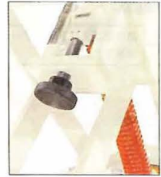
バネ圧はノブの回転によって無段階に調整できます
